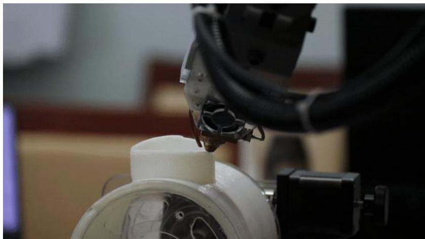
图 7-32 机械臂三维打印过程
