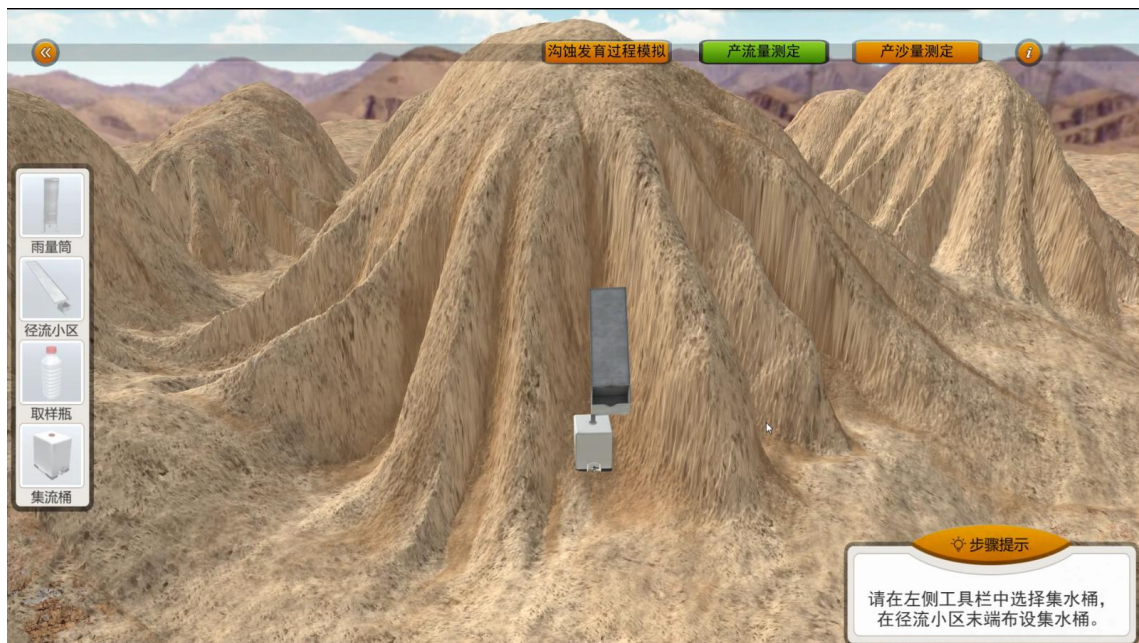
图 48 产流量测定径流小区和集流桶布设
