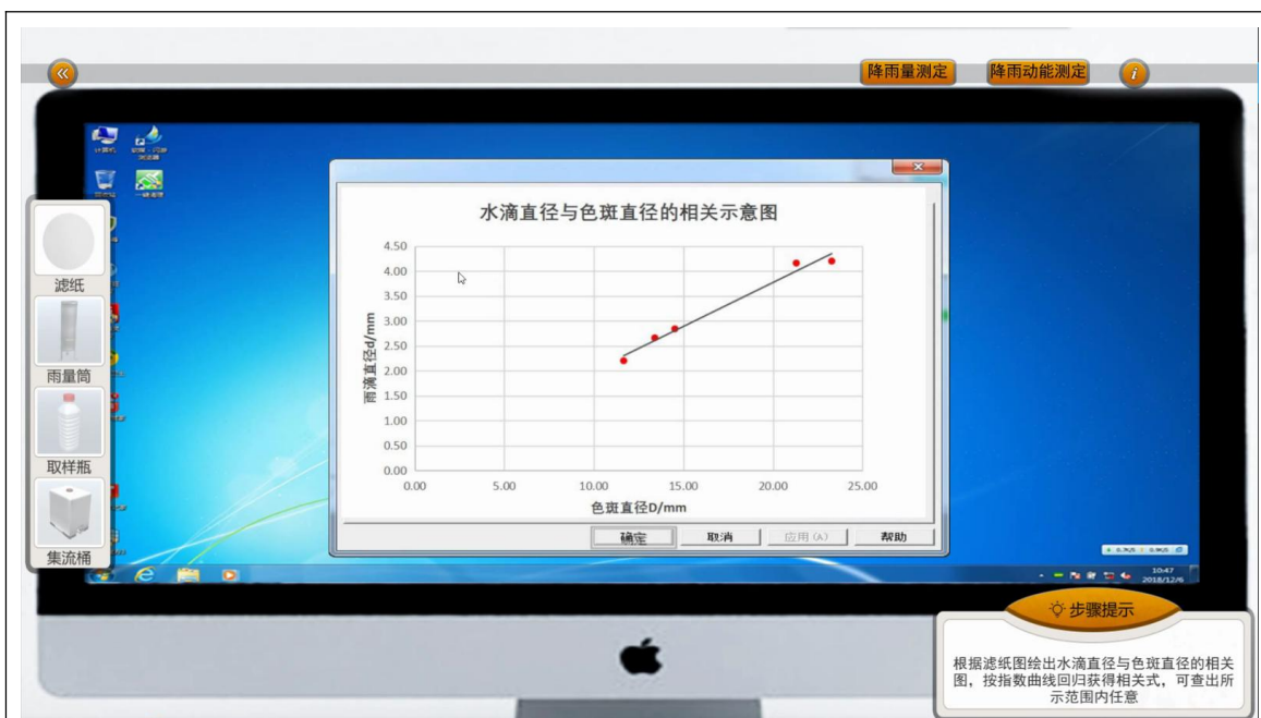
图 35 水滴直径与色斑直径的相关图
