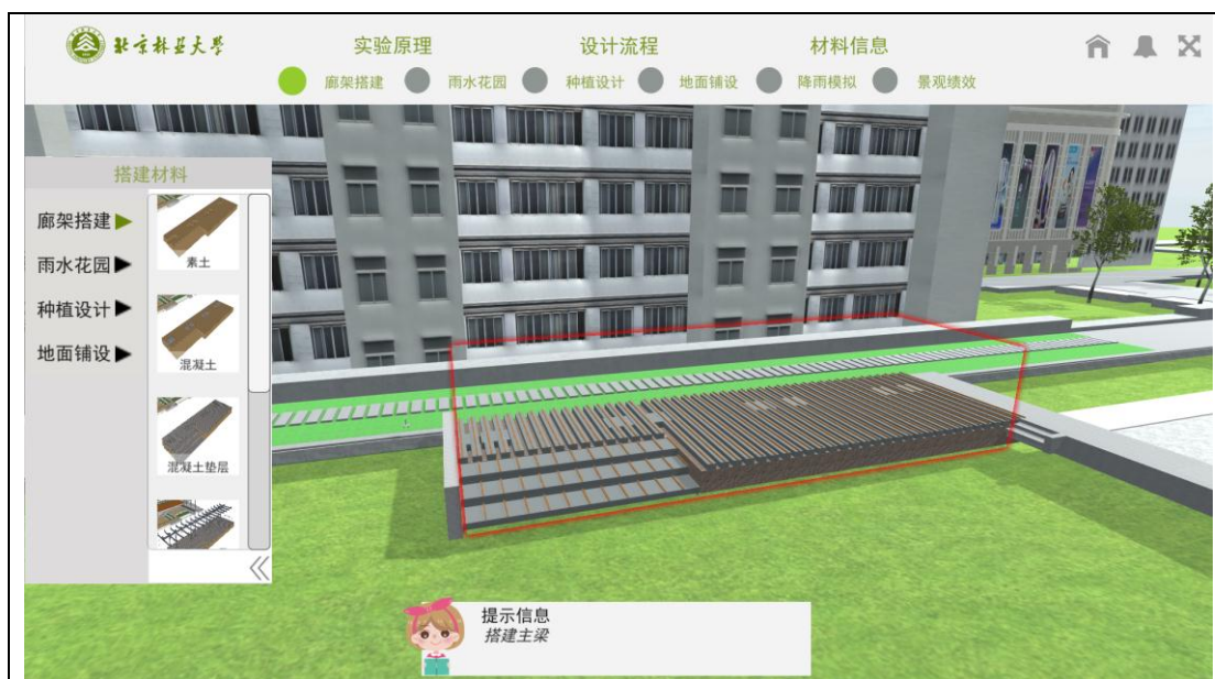
图 34 现代廊架搭建：混凝土垫层
